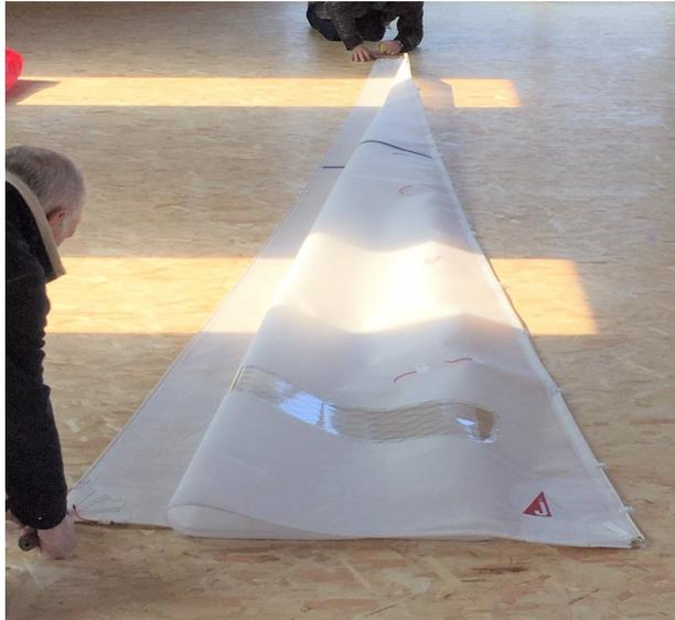
Photo 3 : préparation de la voile pour la mesure de la flèche de chute ( $f_c$ ).
